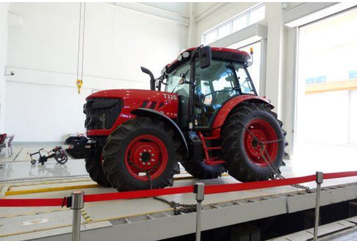
曳引機靜態翻覆角測試
